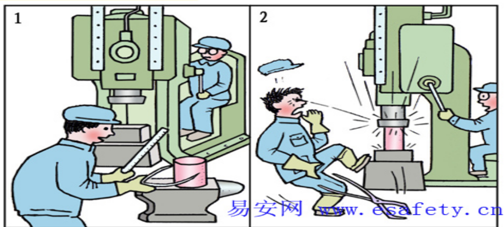
没戴防护镜 铁屑崩瞎眼
