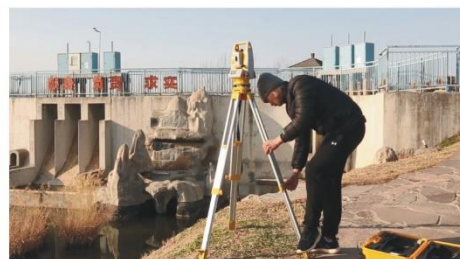
(b) 调节身边另一架腿的高度使圆水准气泡居中
