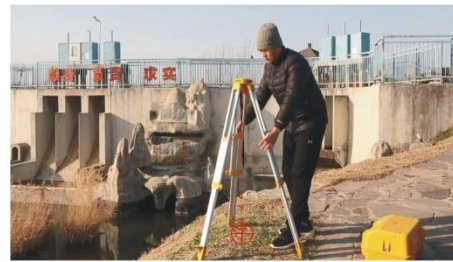
(b) 目估对中并使三脚架架头大致水平
