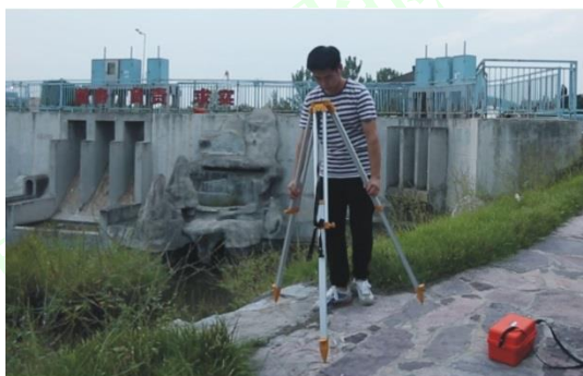
(a) 打开三脚架，伸缩三个架腿使高度适中
