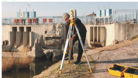
(a) 调节身边一架腿的高度使圆水准气泡与另一架腿在一条直线
