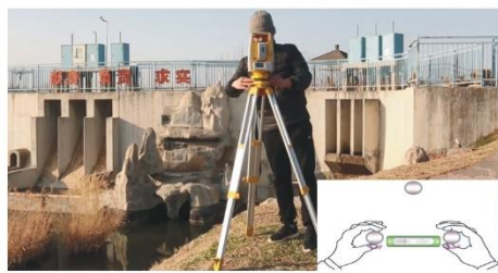
(c) 旋转照准部, 使水准管平行于任一一对脚螺旋, 转动这两个脚螺旋使水准管气泡居中
