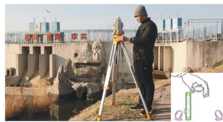
(d) 将照准部旋转90°, 转动第三个脚螺旋使水准管气泡居中
