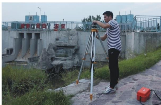
(b) 从仪器箱中拿出仪器，通过中心连接螺旋将仪器固定在三脚架上
