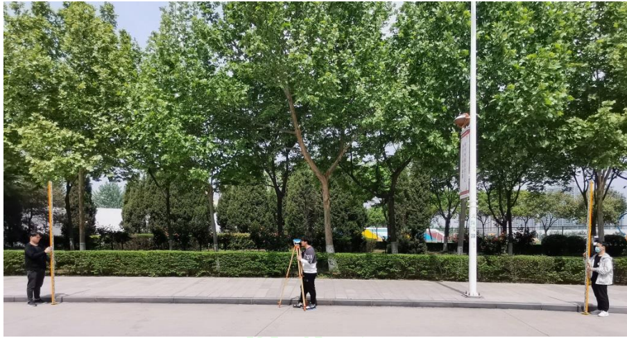
图 1-18 安置水准仪在 A、B 两点中间
