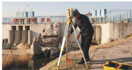
(d) 调节对中器目镜及物镜焦距, 移动两条架腿, 使测站点成像于对中器标志的中心
