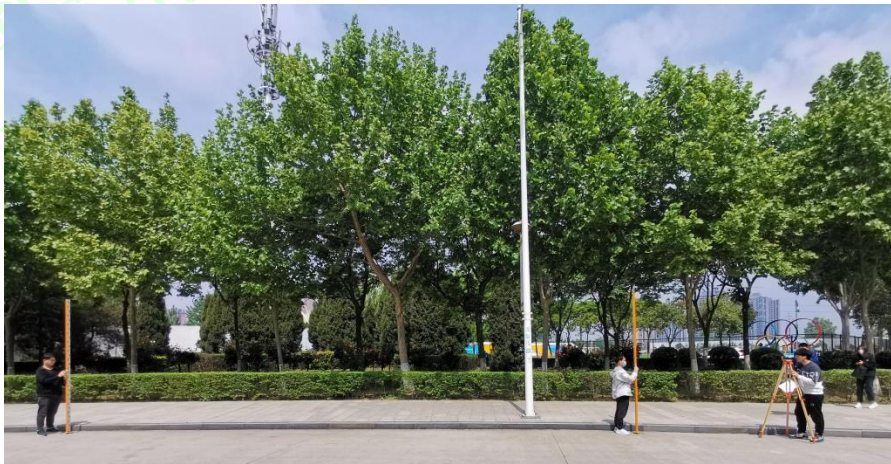
图 1-19 安置水准仪在前视尺附近
